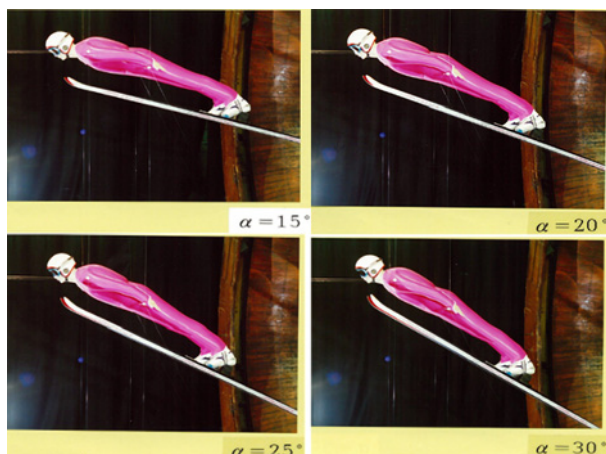
図3 風洞実験（迎角： \alpha 15\sim 30^\circ ）
