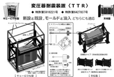
図5 変圧器耐震対策の例
