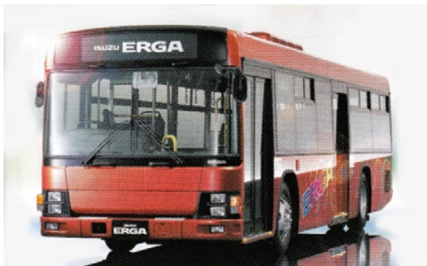
写真3 前中ノンステップバス (いすゞ自動車「大型路線バス エルガ」カタログより引用)
