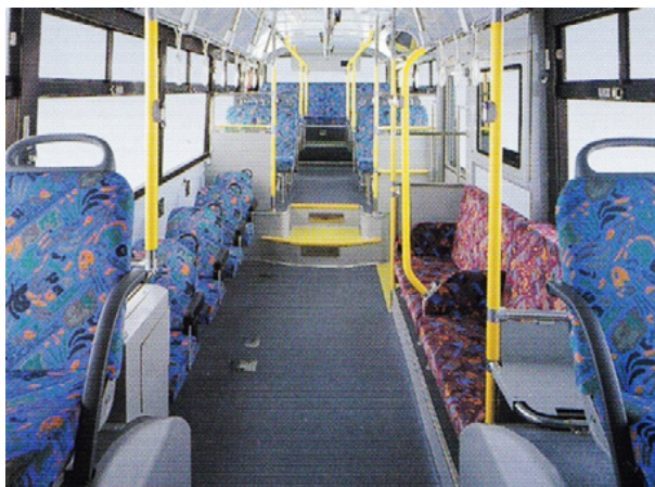
写真4 前中ノンステップバスの室内床段差 (いすゞ自動車「大型路線バス エルガ」カタログより引用)
