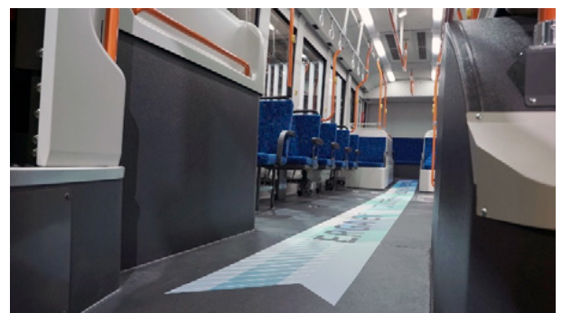
写真6 電動フルフラットノンステップバスの室内床形状 (いすゞ自動車公式Facebookより引用)
