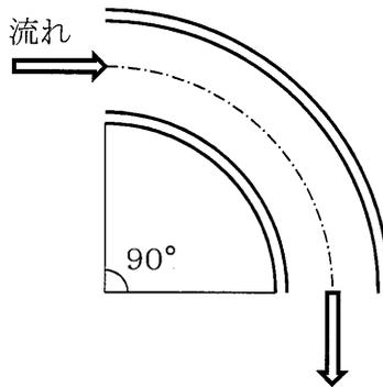
Ⅲ-35 室内の空気を軸流ファンにより室外に排出している。室内の空気は静止しており、排出口では空気の流速は  $20.0 \text{ m/s}$  である。排出口の面積は  $0.07 \text{ m}^2$  であり、室内と排出口での圧力は同じとみなしてよい。このファンの動力が  $0.50 \text{ kW}$  のとき、ファンのエネルギー効率に最も近い値はどれか。ただし、空気の密度は  $1.23 \text{ kg/m}^3$  とし、管路での摩擦抵抗や流れの旋回は無視する。
