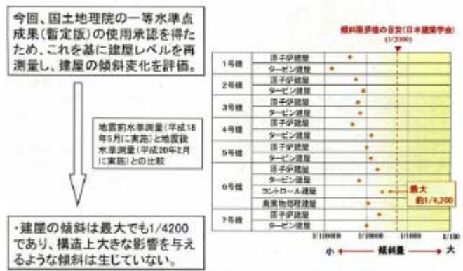
図-3.4.2 建屋の測量結果 (東京電力(株)提供)
