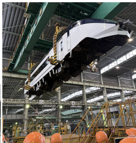
門型クレーンでスカイライナーの車体を持ち上げる作業の見学
