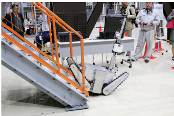
写真5 モックアップ階段を使った試験 5)
