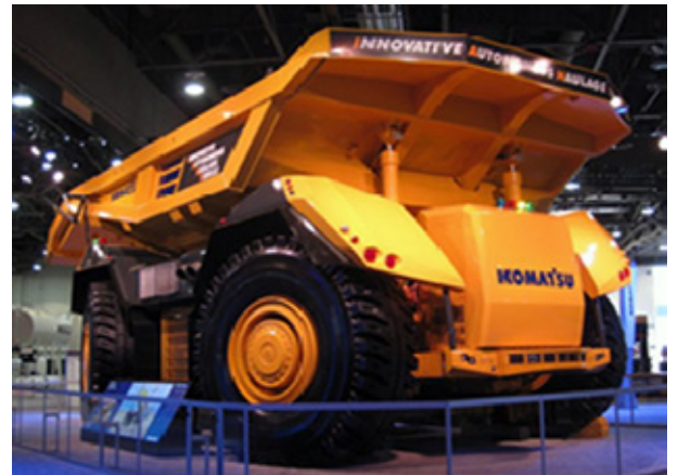
写真2 無人運転席のないダンプトラック (コマツの2016年ニュースリリースに掲載)
