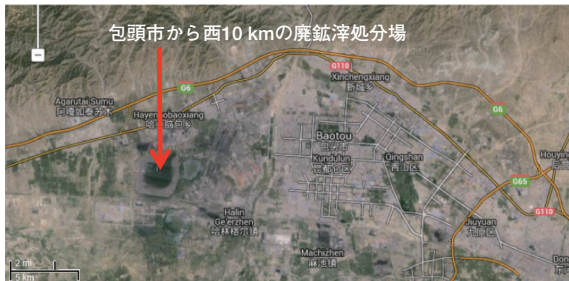
(a) 世界最大のレアアース(希土類)鉱山の(白雲鄂博鉱山)から採掘された精鉱は、包頭市に運ばれて精製される。廃棄物は廃鉱滓処分場(図(b))などで処分される
