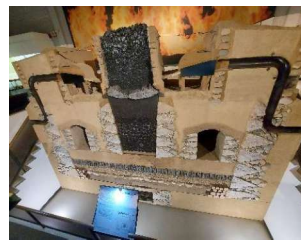
③炉床は断熱と水分の遮断にて炉の温度を上げるための構造。
