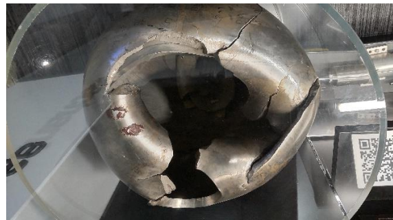
図2 耐圧試験後のチタン球体
