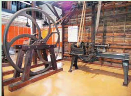
旋盤 一手回し動力装置付き
