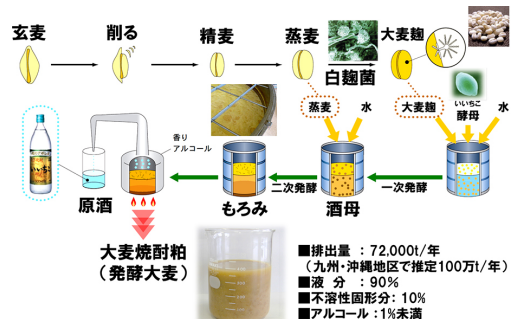
図1 大麦焼酎の製造工程
