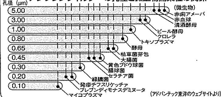
メンブレンフィルターの孔径と微生物捕集性の関係
