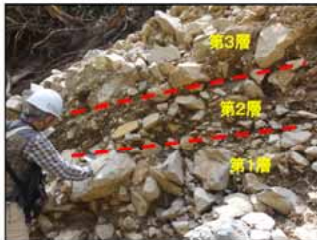
写真 16 土石流堆積物の露頭。3層確認できる。
