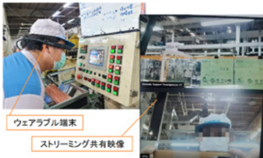
写真1 4K360°カメラによる遠隔作業支援・設備点検
