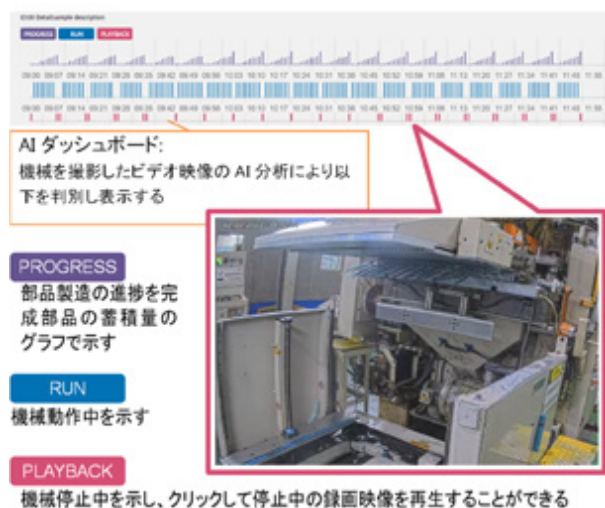
写真2 カメラ映像・機械動作音声のAI分析・判断
