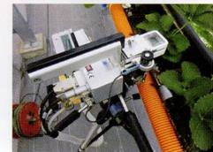
光合成蒸散測定装置
