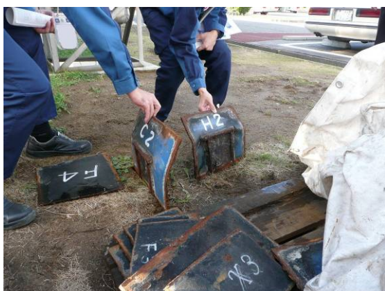
写真-2.4.11 座屈部の側板試料(東電提供)
