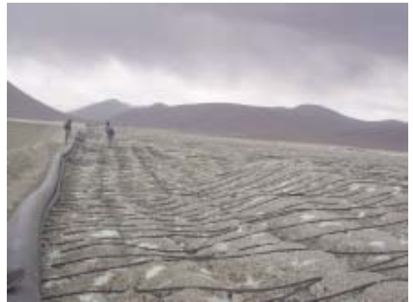
写真2 Heap 表面の酸液散水
