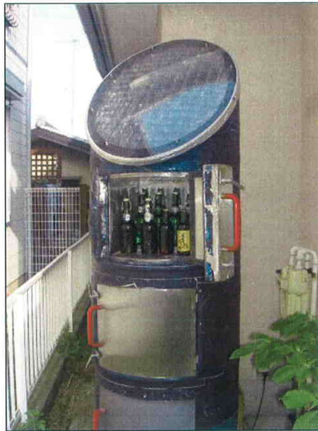
2001年7月製作の非電化冷蔵庫第1号機 ドラム缶を2個つなげて作った
