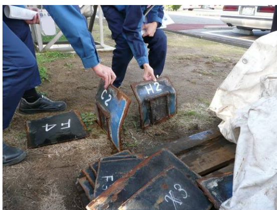
写真-2.4.11 座屈部の側板試料(東電提供)
