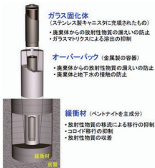
図3 高レベル廃棄物処分場の人工バリアの構成と安全機能 5)
