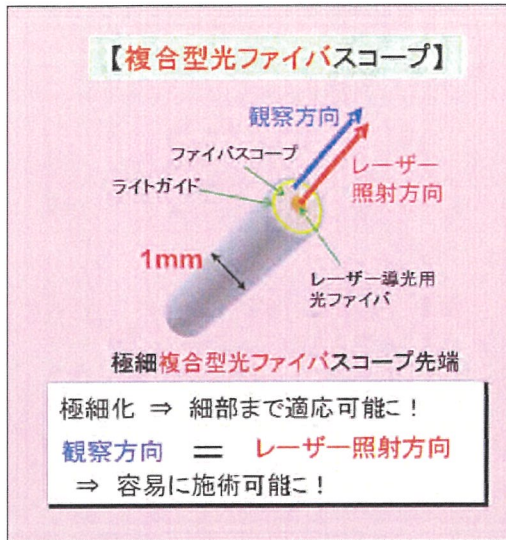
図6 極細複合型光ファイバスコープの開発
