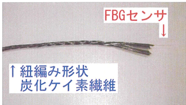
図14 紐編み形状炭化ケイ素繊維で保護したFBGセンサ
