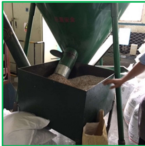
①原料樹脂ポロプロピレンの混合
