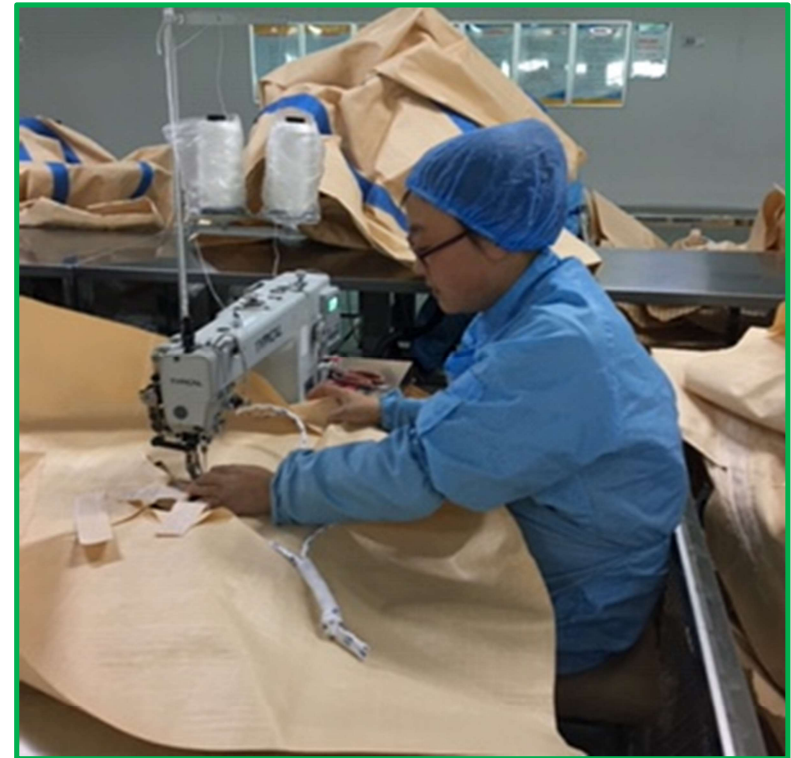
⑥マシンによる部品取付け
