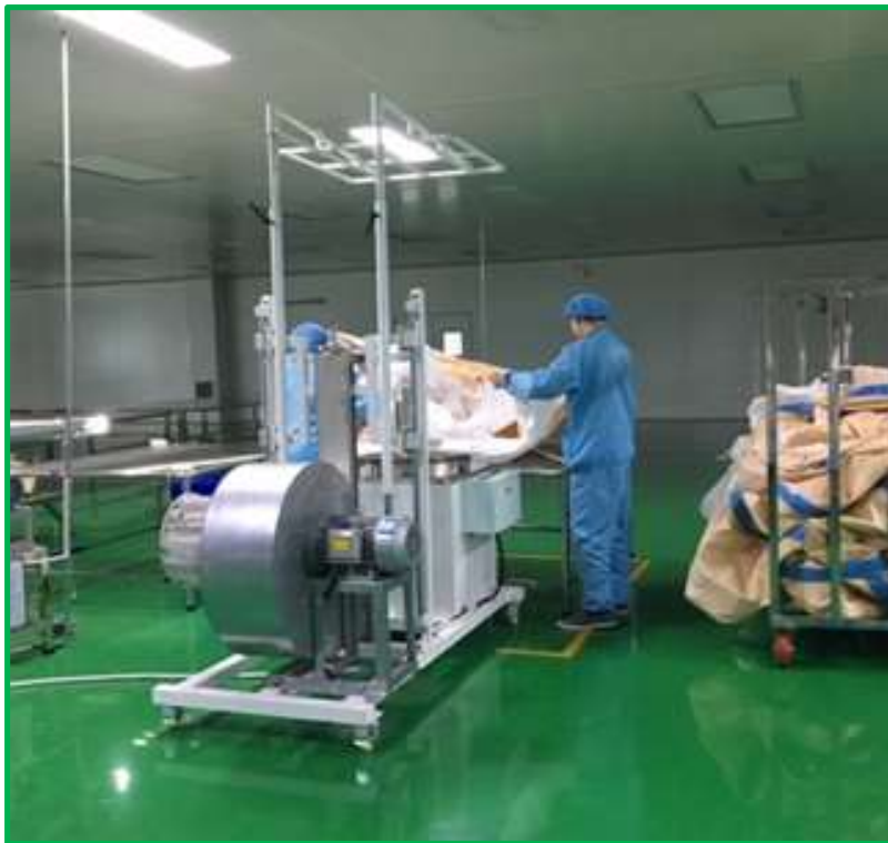
⑦クリーンルームでの袋内部清浄化作業
