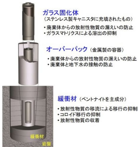
図3 高レベル廃棄物処分場の人工バリアの構成と安全機能 5)
