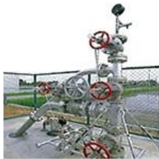
写真2 天然ガス生産井（関東天然瓦斯開発様ウェブサイトより）
